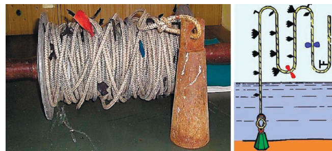
Лот - прибор для измерения глубины
